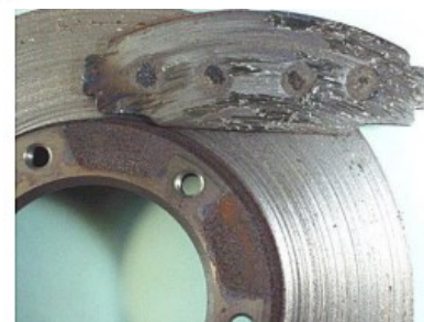
Пример повреждения тормозного диска основанием колодки вследствие полного износа фрикционного материала
