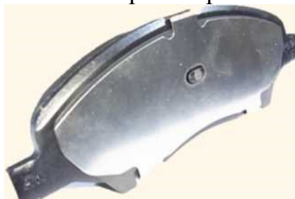
Пластина, установленная на колодку
